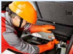
Staccare il connettore di servizio dalla fonte di energia. Indossare guanti isolanti, abbigliamento di protezione a maniche lunghe e casco di protezione contro gli archi elettrici.
