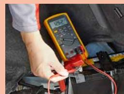
Verificare di nuovo lo strumento di misura sulla batteria 12 V (punto 3 della regola dei 3 punti).
