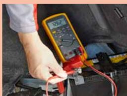
Verificare lo strumento di misura su una batteria 12 V (punto 1 della regola dei 3 punti).
