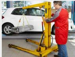
Per lo smontaggio utilizzare adeguati dispositivi di fissaggio e di sollevamento (ergonomia!).
