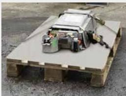
Collocare e fissare le batterie ad alta tensione da trasportare su un supporto isolato.
