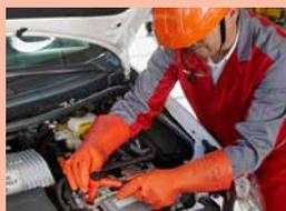
Aprire l'alloggiamento dell'elettronica di potenza.
