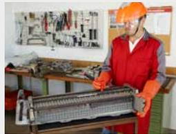
Separare per quanto possibile i moduli dell'accumulatore per ridurre il potenziale energetico. Riparare o sostituire i moduli dell'accumulatore difettosi.
