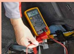
Verificare lo strumento di misura sulla batteria 12 V (punto 1 della regola dei 3 punti).
